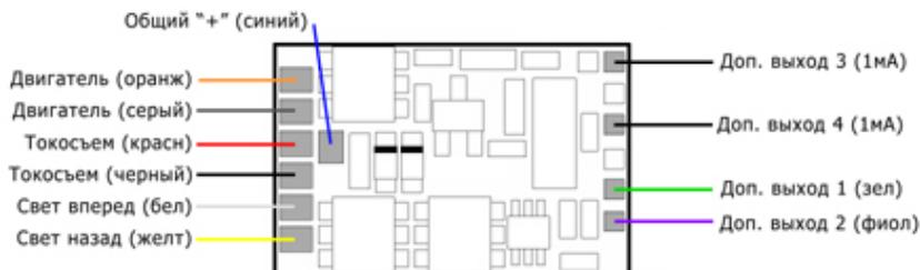
Схема подключения при отсутствии в модели платы с разъемом:
